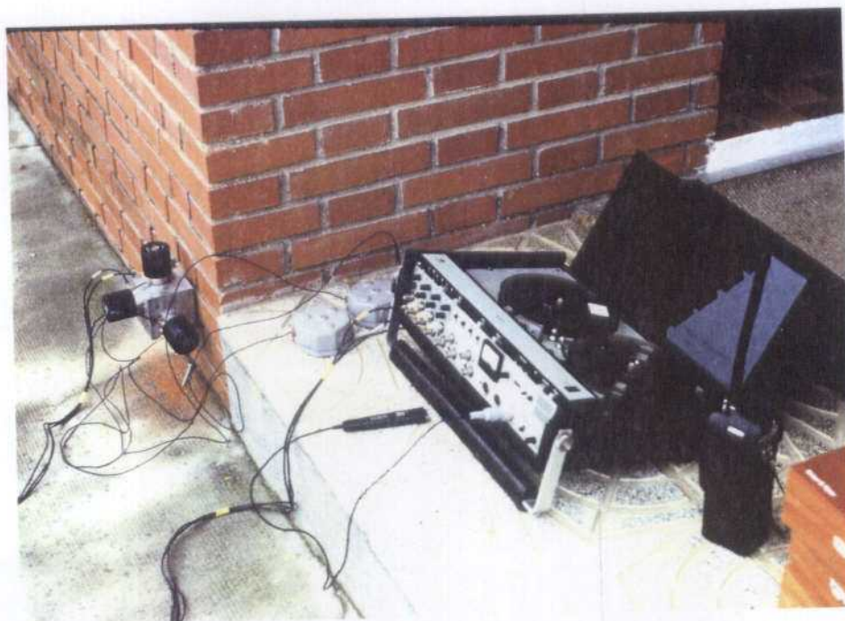
Foto 9. Estación de medida nº 4 y equipo de registro empleado
